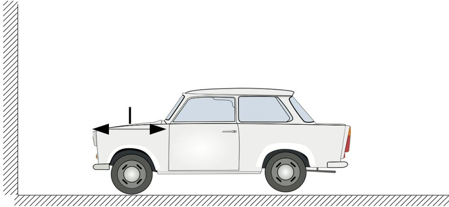
Bei einem Crash-Test fährt ein Versuchsfahrzeug mit einer Geschwindigkeit  $v_0$  gegen eine Wand. Während des Knautschvorgangs wird eine Beschleunigung von  $a_0 = -a_0 (e^{t/T} - 1)$  gemessen. Dabei sei  $l$  die Länge der Knautschzone, welche komplett zusammengedrückt wird.
