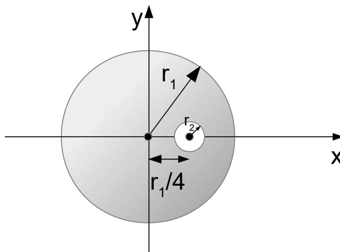
Aus der obigen Kreisfläche ist ein Kreis mit dem Radius  $r_2$  ausgeschnitten worden. Es soll der Schwerpunkt für die Restfläche bestimmt werden.
