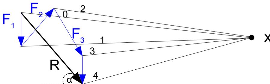
Die Abtragung der Polstrahlen beginnt beim Anfangspunkt von  $F_1$  (Polstrahl 0) und endet beim Endpunkt (Spitze) von  $F_4$  (Polstrahl 4).
