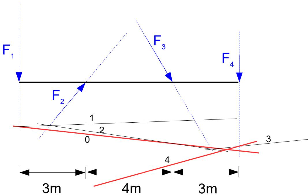
Nachdem der Schnittpunkt gefunden ist, wird als nächstes die mittels grafischer Vektoraddition ermittelte Resultierende in diesen Punkt gelegt und solange auf ihrer Wirkungslinie nach oben verschoben, bis die Resultierende am Balken angreift:
