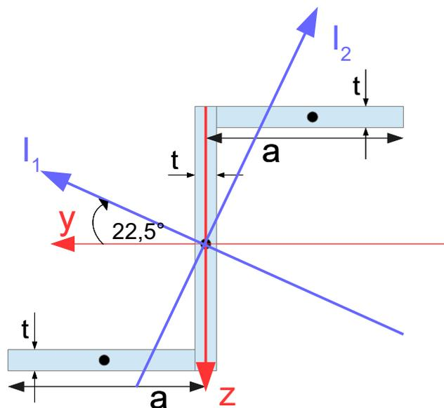
**Merke:** Ein positiver Winkel bedeutet eine positive Drehrichtung (Linksdrehung).
