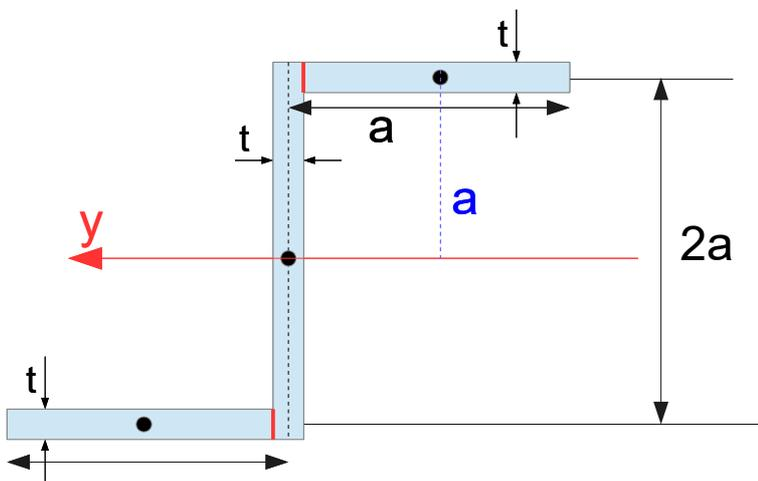
Der Abstand von der Mitte des oberen Rechtecks zur Mitte des unteren Rechtecks beträgt  $2a$ . Da sich das Koordinatensystem im Schwerpunkt des mittleren Rechtecks befindet beträgt der Abstand:
