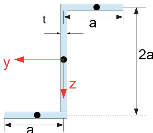
Der nächste Schritt ist nun die Bestimmung der Flächenträgheitsmomente der Teilflächen bezüglich ihrer Schwerpunktsachsen. Das obige Rechteck wird bis zur roten Linie betrachtet. Die Breite beträgt demnach  $a - t/2$ . Genau dasselbe gilt für die Breite des unteren Rechtecks. Die Höhe des mittleren Rechtecks beträgt dann  $2a + t/2 + t/2$ , weil die Höhe von  $2a$  nur bis zur Mitte des oberen und unteren Rechtecks gilt.
