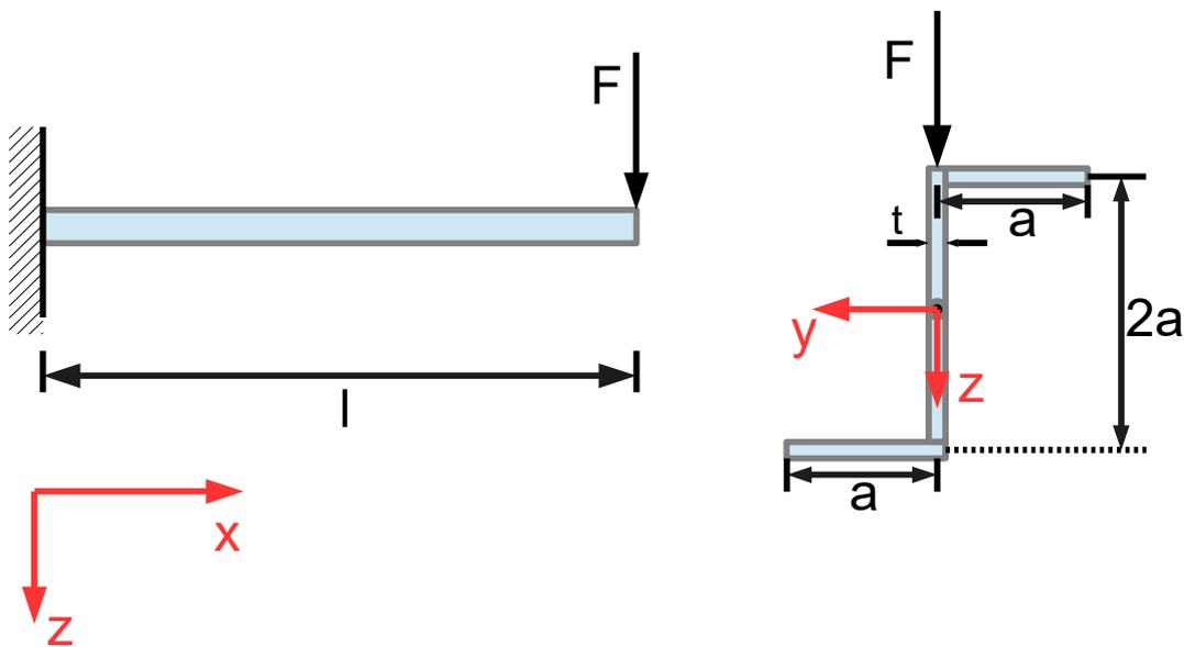
Gegeben sei der obige Kragträger, welcher durch eine Kraft  $F$  in  $z$ -Richtung belastet wird. Der Querschnitt des Kragträgers ist rechts abgebildet und besitzt eine S-Form. Es sei  $t \ll a$ . Gegeben sind:  $t$ ,  $a$ ,  $F$ ,  $l$ ,  $E$ .
