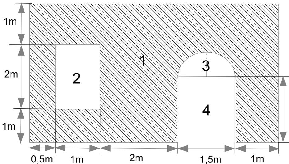
2. Danach werden die Schwerpunkte der Einzelflächen eingetragen. Bei Rechtecken liegt der Schwerpunkt in der Mitte. Bei einem Halbkreis bei  $y = \frac{4r}{3\pi}$ :
