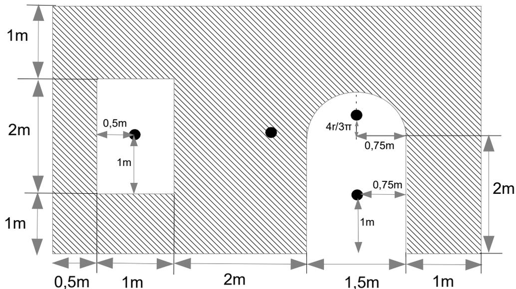
3. Festlegung des Bezugskordinatensystems: Das Bezugskordinatensystem kann willkürlich gewählt werden, muss aber innerhalb der Abmessungen liegen. D.h. von den Schwerpunkten der Teilflächen müssen die Abmessungen in x- und y-Richtung zum Bezugskordinatensystem gegeben sein.
