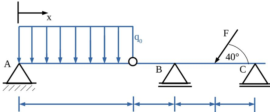
Das skizzierte System wird durch eine rechteckige Streckenlast (auch: Gleichstreckenlast)  $q$  und eine Einzelkraft  $F$  belastet.
