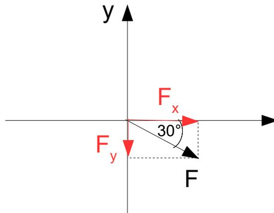
Grundlage für die Berechnung der Kraftkomponenten  $F_x$  und  $F_y$  ist hier die Trigonometrie am rechtwinkligen Dreieck.
