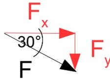
Mittels Trigonometrie am rechtwinkligen Dreieck können wir nun die Kraftkomponenten bestimmen. Die Resultierende  $F$  ist die Hypotenuse und ist bekannt. Der Winkel zwischen  $F$  und  $F_x$  ist bekannt. Demnach ist  $F_x$  die Ankathete und  $F_y$  die Gegenkathete.
