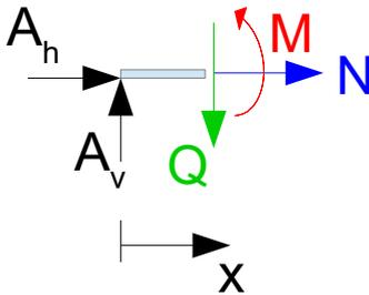
Wir beginnen damit die Gleichgewichtsbedingungen aufzustellen, um die Schnittgrößen bestimmen zu können. Die Normalkraft kann aus der Gleichgewichtsbedingung in x-Richtung berechnet werden. Die Querkraft aus der Gleichgewichtsbedingung in z-Richtung und das Biegemomente aus der Momentengleichgewichtsbedingung.
