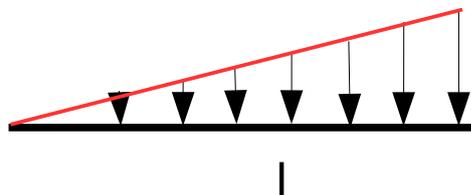
$q(x)$  ist die rot gekennzeichnete Funktion:
