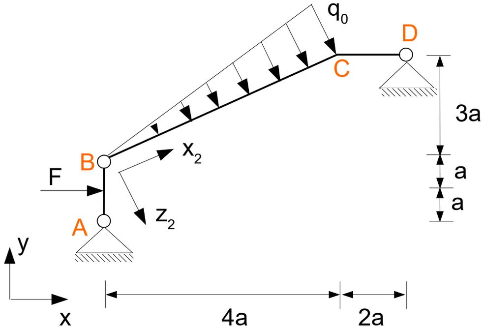
Berechne die Schnittgrößen für den Bereich BC in dem angegebenen lokalen Koordinatensystem und gebe die Randwerte bei B und C an.
