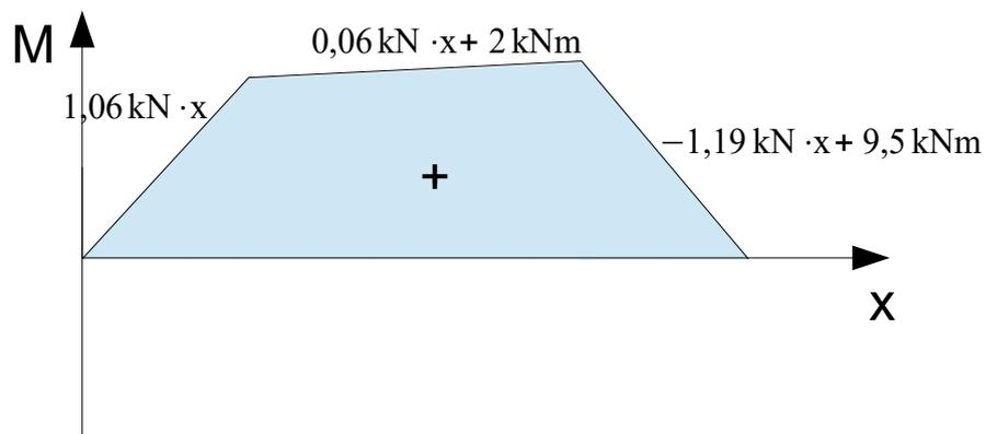
**Zusammenhang zwischen Streckenlasten und Schnittgrößen**
