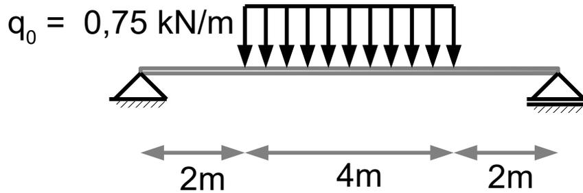
Zunächst wird der Balken von den Lagern gelöst und die Streckenlast zu einer einzigen Kraft zusammengefasst. Dazu muss der Flächeninhalt der Fläche berechnet werden. Hierbei handelt es sich um eine rechteckige Fläche, demnach :  $q_0 \cdot 4m$
