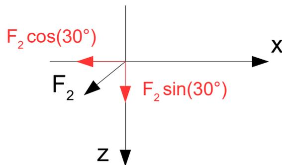
3. Freischnitt unter Berücksichtigung der Kräftezerlegung
