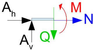
Wir beginnen damit die Gleichgewichtsbedingungen aufzustellen, um die Schnittgrößen bestimmen zu können. Die Normalkraft kann aus der Gleichgewichtsbedingung in x-Richtung berechnet werden. Die Querkraft aus der Gleichgewichtsbedingung in z-Richtung und das Biegemomente aus der Momentengleichgewichtsbedingung.
