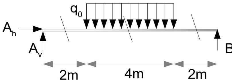
Liegt eine Streckenlast  $q(x)$  vor so muss zusätzlich ein Schnitt zwischen dieser Last durchgeführt werden. Insgesamt werden also drei Schnitte betrachtet:
