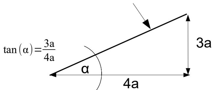
Für die Kräftezerlegung benötigen wir den Winkel von der Resultierenden zur Horizontalen. Wir können zunächst mittels Trigonometrie am rechtwinkligen Dreieck den Winkel zwischen der Schrägen (auf welche die Resultierende wirkt) und der Horizontalen bestimmen (siehe obige Grafik).
