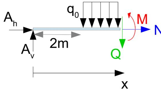
Es wird der Schnitt durch die Streckenlast durchgeführt. Es ist nun sinnvoll die Streckenlast mit dem Integral zu berücksichtigen. Dazu benötigen wir  $q(x)$ . Bei einer rechteckigen Streckenlast ist  $q(x) = q_0$ .
