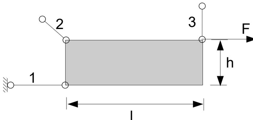
**Hinweis:** Pendelstäbe sind an beiden Enden mit Momentengelenken verbunden (2 und 3). Pendelstützen sind Pendelstäbe die das System mit Auflagern verbinden (1). In beiden Fällen werden nur Kräfte entlang der Stabachse übertragen.
