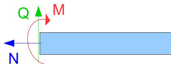
Mittels der Gleichgewichtsbedingungen können die Schnittgrößen berechnet werden.
