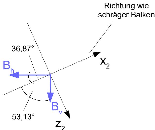
$$B_h \cdot \cos(36,87^\circ) = B_h \cdot \frac{4}{5} \quad \text{Kraftkomponente in negative } x_2\text{-Richtung}$$
