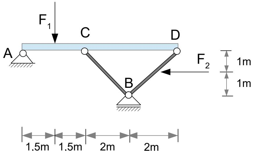
Gegeben sei das obige Tragwerk, welches durch die zwei Kräfte  $F_1 = 1,5 \text{ kN}$  und  $F_2 = 150 \text{ N}$  belastet wird.
