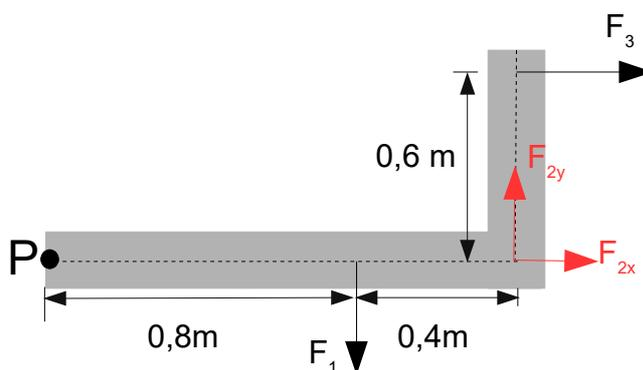
Wir beginnen mit der Kraft  $F_1$ . Der Hebelarm ist der senkrechte Abstand der Kraft  $F_1$  zum Bezugspunkt P. Hierfür verschieben wir die Kraft  $F_1$  gedanklich solange parallel zu sich selbst, bis die Kraft (oder ihre Wirkungslinie) den Bezugspunkt schneidet. In diesem Fall ist der senkrechte Abstand  $h_1 = 0,8$  m. Der Drehsinn ist negativ, weil die Kraft  $F_1$  den Balken in einer Rechtsdrehung um den Bezugspunkt dreht:
