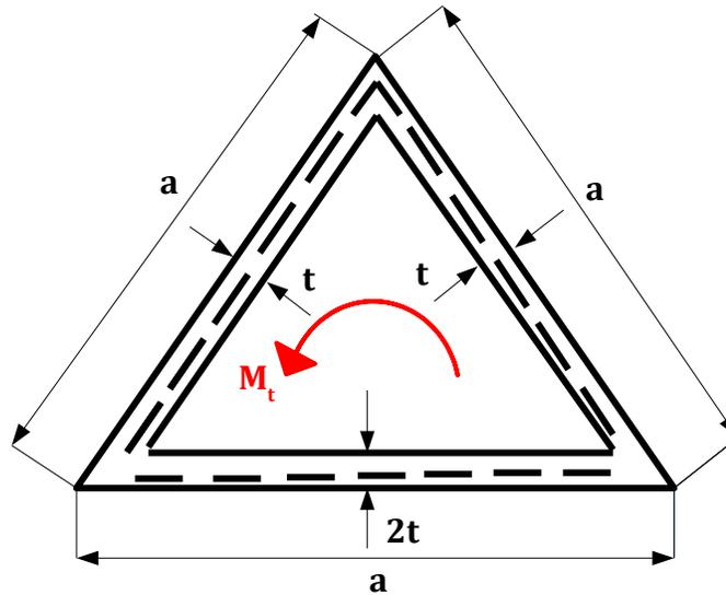
Ein dünnwandiger Träger mit den **Wandstärken**  $h$  und  $2h$  und der **Länge**  $l$  hat die oben gezeichnete Querschnittsform und wird durch ein Torsionsmoment  $M_t$  beansprucht.
