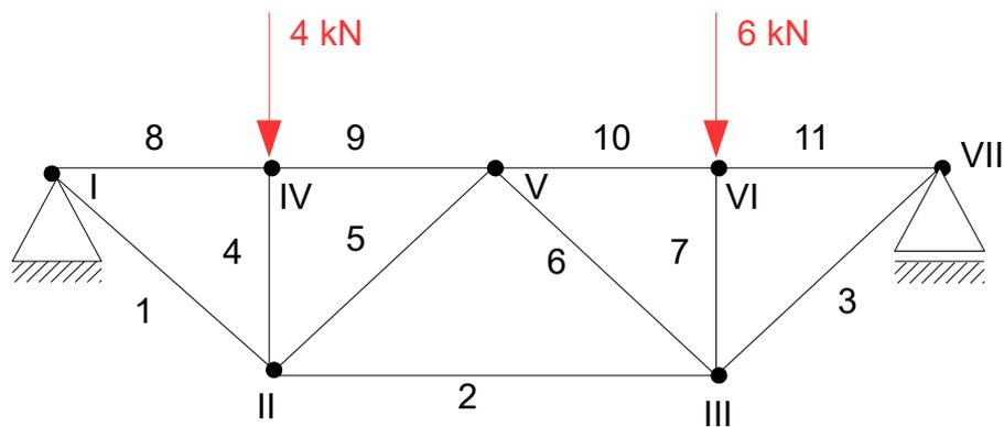
Gegeben sei das obige Fachwerk welches durch die beiden äußeren Kräfte belastet wird. Es sollen alle unbekannt Stabkräfte zeichnerisch mittels **Cremonaplan** bestimmt werden.
