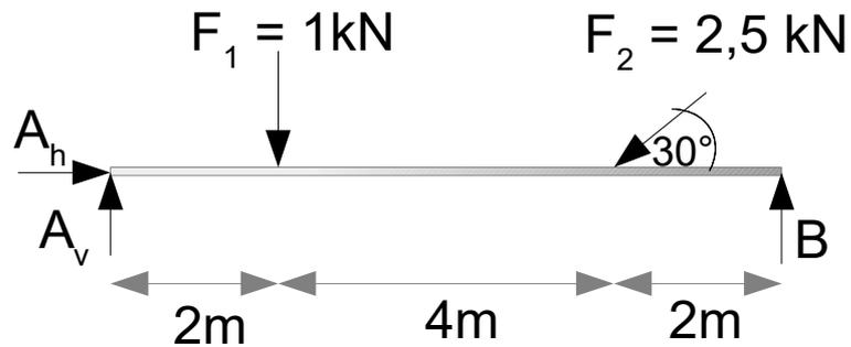
Bevor wir mit der Berechnung der Schnittgrößen beginnen, wird zunächst die Kraft  $F_2$  in ihre Komponenten zerlegt:
