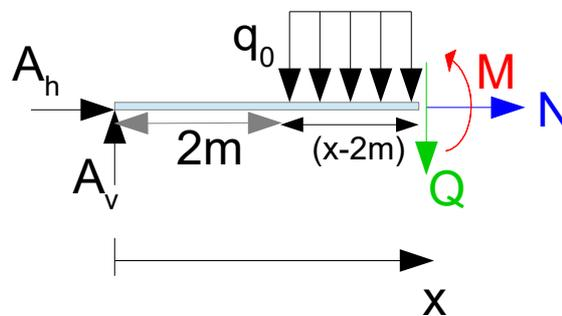
Es resultiert demnach die Einzellast, indem die Fläche der Teillast bestimmt wird:
