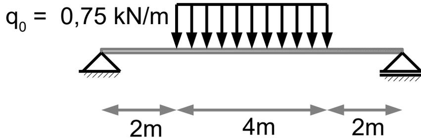
Zunächst wird der Balken von den Lagern gelöst und die Streckenlast zu einer einzigen Kraft zusammengefasst. Dazu muss der Flächeninhalt der Fläche berechnet werden. Hierbei handelt es sich um eine rechteckige Fläche, demnach :  $q_0 \cdot 4\text{m}$
