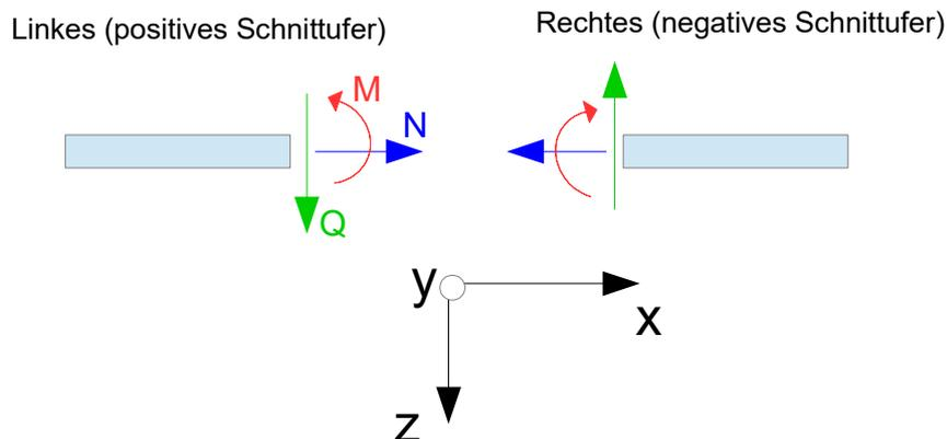
Am linken (positiven) Schnittufer zeigen die Schnittgrößen in positive Achsenrichtung in Bezug auf das obige x,y,z-Koordinatensystem. Das Moment ist am linken Schnittufer ein linksdrehendes Moment, welches in der Physik als positives Moment definiert ist. Am rechten (negativen) Schnittufer zeigen die Schnittgrößen in negative Achsenrichtung. Das Moment ist hierbei ein rechtsdrehendes Moment.
