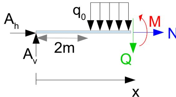
Es wird der Schnitt durch die Streckenlast durchgeführt. Als nächstes muss diese Teilstreckenlast wieder zu einer Einzellast zusammengefasst werden (in Abhängigkeit von  $x$ ):
