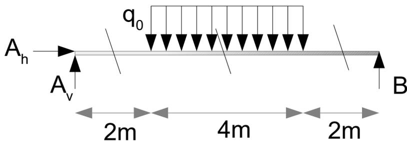
Liegt eine Streckenlast bzw. Dreieckslast vor so muss zusätzlich ein Schnitt zwischen dieser Last durchgeführt werden. Insgesamt werden also drei Schnitte betrachtet:
