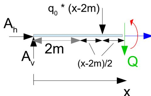
Die Einzellast greift im Schwerpunkt der Teilstreckenlast an. Der Schwerpunkt bei einer rechteckigen Last liegt in der Mitte. Die Teilstreckenlast hat eine Länge von  $(x-2m)$ , die Mitte ist also  $(x-2m)/2$ . Der Abstand zum Schnitt hin beträgt demnach  $(x-2m)/2$ .
