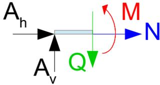
Wir beginnen damit die Gleichgewichtsbedingungen aufzustellen, um die Schnittgrößen bestimmen zu können. Die Normalkraft kann aus der Gleichgewichtsbedingung in x-Richtung berechnet werden. Die Querkraft aus der Gleichgewichtsbedingung in z-Richtung und das Biegemomente aus der Momentengleichgewichtsbedingung.
