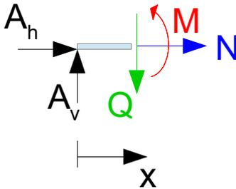
Wir beginnen damit die Gleichgewichtsbedingungen aufzustellen, um die Schnittgrößen bestimmen zu können. Die Normalkraft kann aus der Gleichgewichtsbedingung in x-Richtung berechnet werden. Die Querkraft aus der Gleichgewichtsbedingung in z-Richtung und das Biegemomente aus der Momentengleichgewichtsbedingung.
