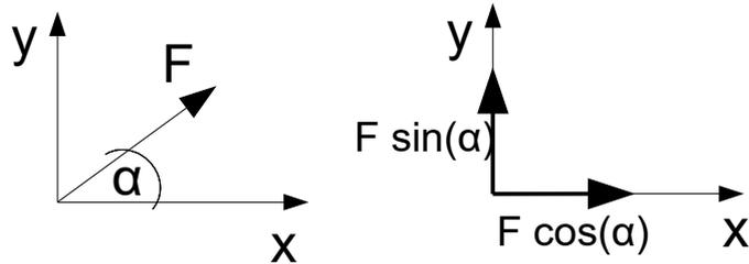
$F_3$  und  $F_4$  müssen in ihre Horizontal- und Vertikalkomponente zerlegt werden!
