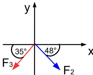
$$F_3 \cdot \cos(35^\circ) \quad \text{x-Komponente (nach links gerichtet)}$$
