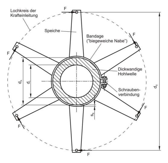
Für die Klemmverbindung gelten weiterhin folgende Konstruktionsdaten in Verbindung mit der Konstruktionsskizze:
