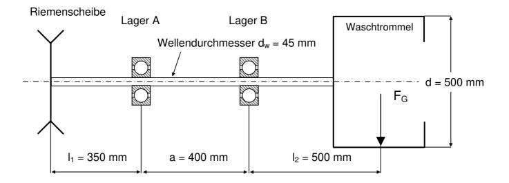
a) Wählen Sie für die Lagerstelle auf der Riemenseite (Lager A) und für die trommelseitige Lagerstelle (Lager B) aus unten stehender Tabelle ein Rillenkugellager aus, unter Berücksichtigung, dass die nominelle Lebensdauer Lh 500 h betragen soll.
