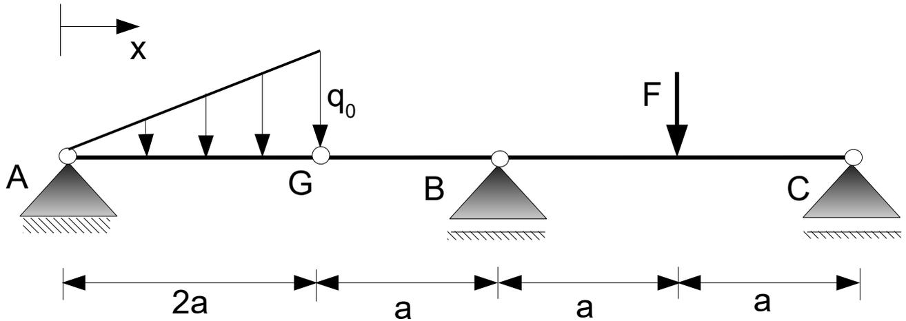
a) Berechne alle Auflager- und Gelenkkräfte!
