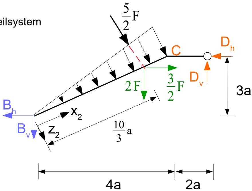
**c) Bestimmung der Auflager- und Gelenkkräfte aus den Gleichgewichtsbedingungen.**
