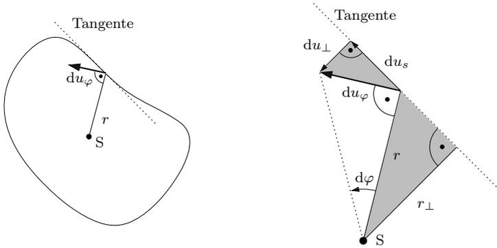
Bild 13.17 Kinematik der Torsion eines dünnwandigen geschlossenen Querschnitts
