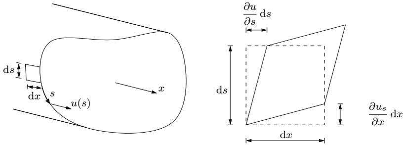
Bild 13.16 Schubverformung eines dünnwandigen geschlossenen Profils
